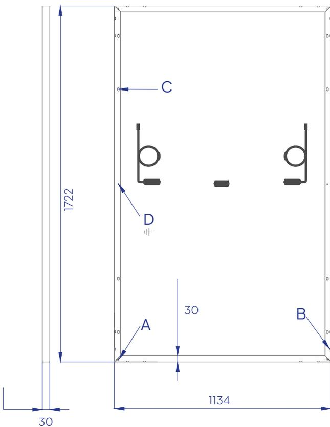
A: Entwässerung; B: Belüftung; C: Befestigungslöcher; D: Erdung;
